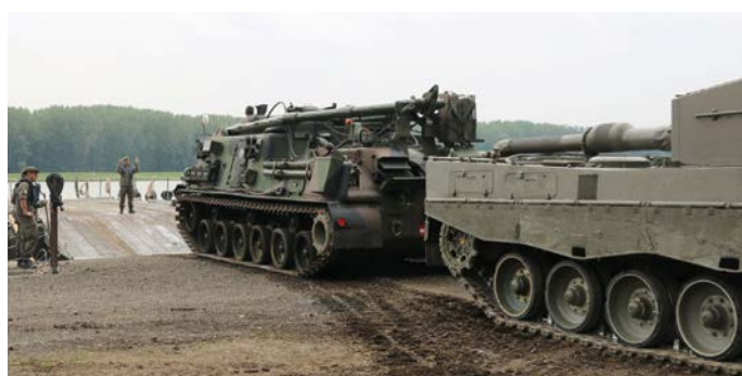
Ein M88-Bergepanzer zieht einen Kampfpanzer „Leopard“ auf die 85-Tonnen-Fähre.
